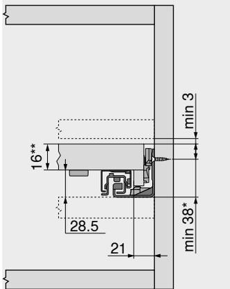
\* +1 mm si las guías se instalan antes de montar el cuerpo
