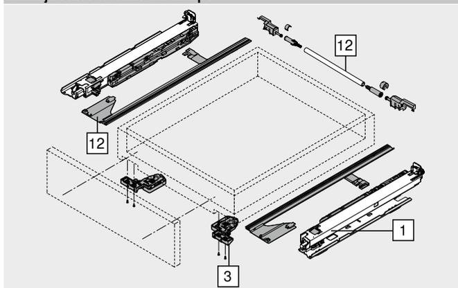
MOVENTO con BLUMOTION – 760H – montaje sobre el fondo del cuerpo – cajón
