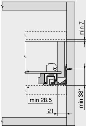
\* +1 mm si las guías se instalan antes de montar el cuerpo
