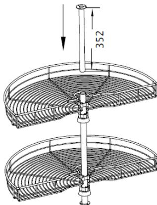
**4** Instale el set en la esquina del módulo, ajuste y fije la montadura inferior y superior al interior del módulo.
