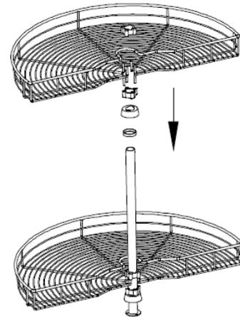
**3** Conecte la montadura superior a la montadura inferior.
